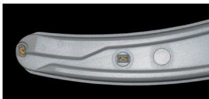
Zbytky jídel blokuji ostříkovací ramena
