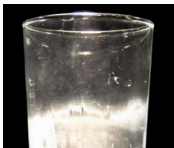
Částečný až úplný nevratný zákal
